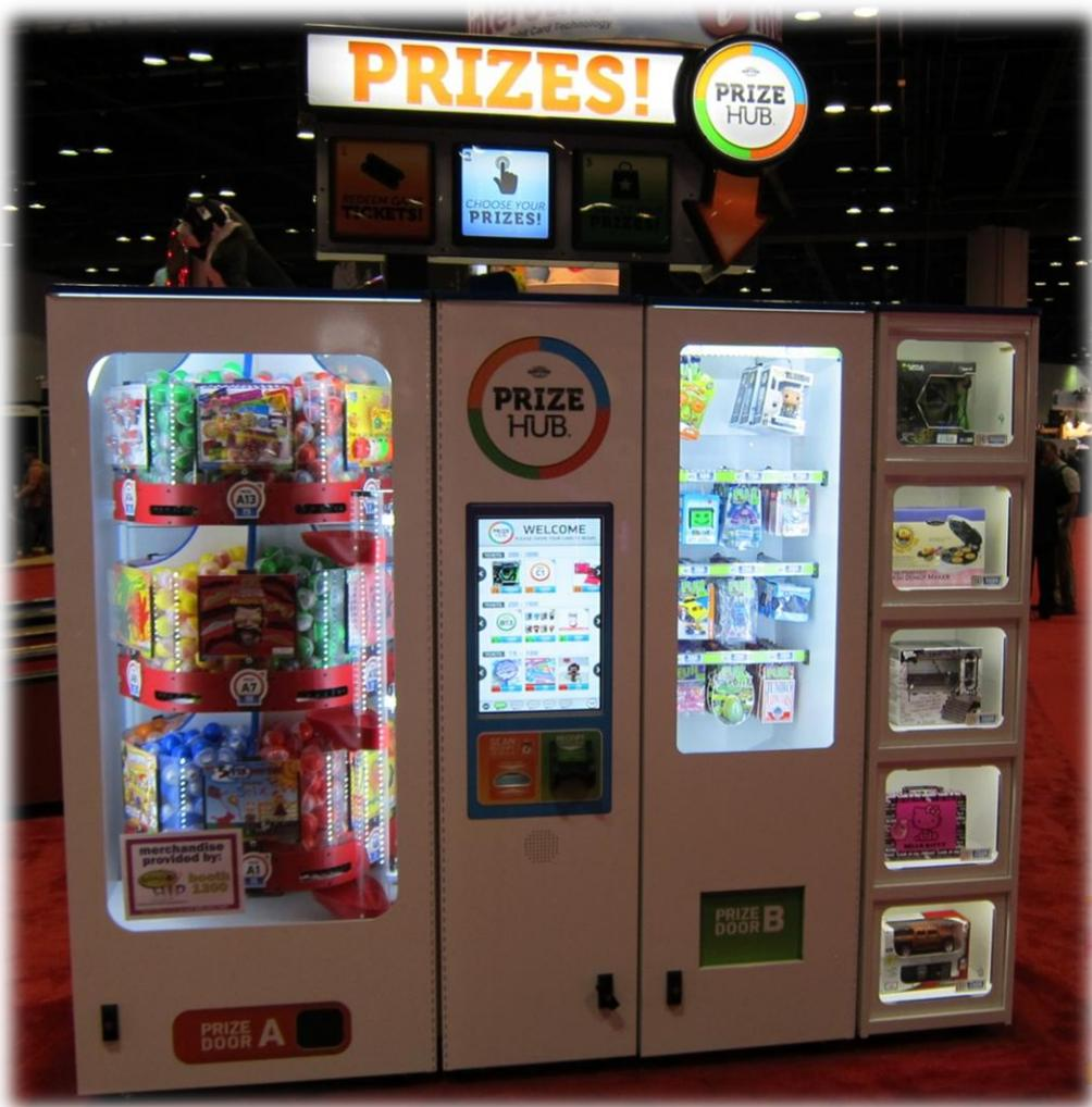
Автоматическая призотека от компании Baytek. Выдает призы клиенту в обмен на выигранные билеты. В зависимости от формы и размера приза вы можете выбрать один из трех отсеков для его размещения: капсула для мелких предметов, штырь для подвешивания или отдельный ящик для крупных или дорогих призов. Сенсорный экран с интуитивным меню делает призотеку простой в использовании.
